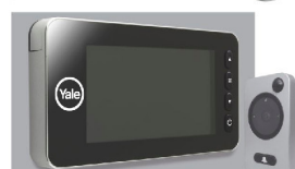
DIGITALER TÜRSPION - SPY 3 - SET Ausmaß des Türspions 45x76mm Einbau ausführbar in die Türöffnungen 38-110mm stark Größe des Bildschirms 138x79mm - 4.3" Blickwinkel 110°
