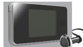
DIGITALER TÜRSPION - SPY 1 - SET Ausmaß des Türspions Ø32mm Einbau ausführbar in die Türöffnungen 38-110mm stark Größe des Bildschirms 125x68mm - 3.2" Blickwinkel 105°
